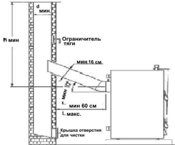
Рис. 6 Пример подключения к дымоходу
